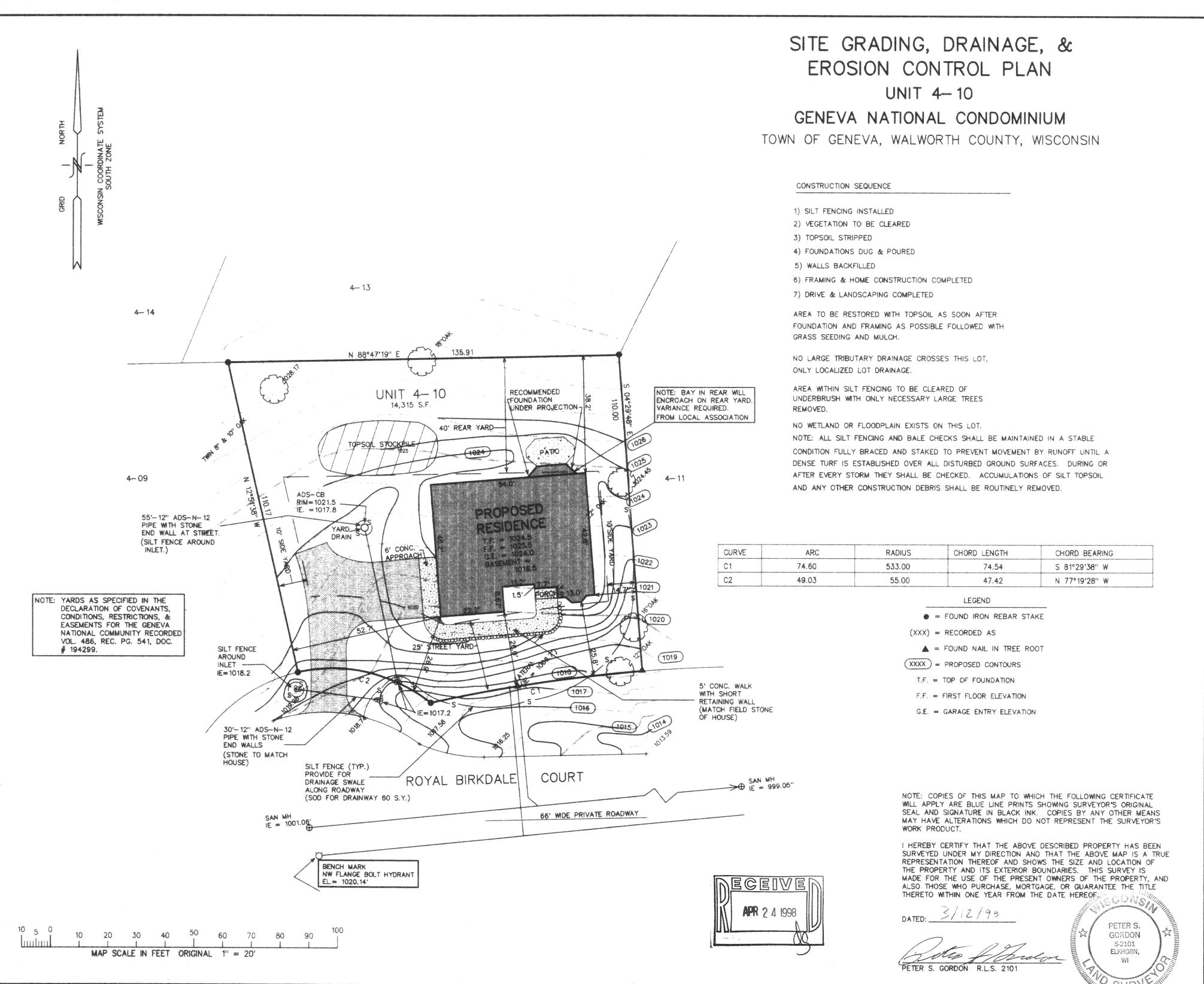
SITE GRADING, DRAINAGE, & EROSION CONTROL PLAN
